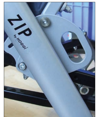
Befestigungspunkte, hinten nach ISO 7176-19
