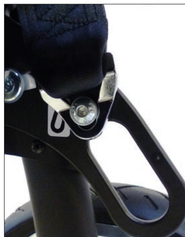
Befestigungspunkt, hinten nach ISO 7176-19 für Beckengurt
